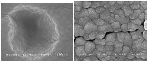
(c) Void (d) Cracks
